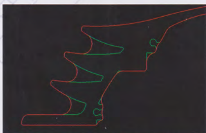
輪郭加工 NC径補正(工具径干涉付)
