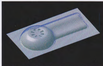
走査線仕上げ加工
