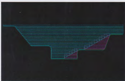
軸並行荒加工 片刃干渉と取り残し
